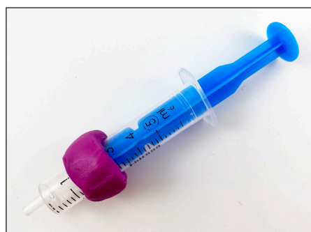
Obr. 2.1.2 Príprava potápača (plastelína)
